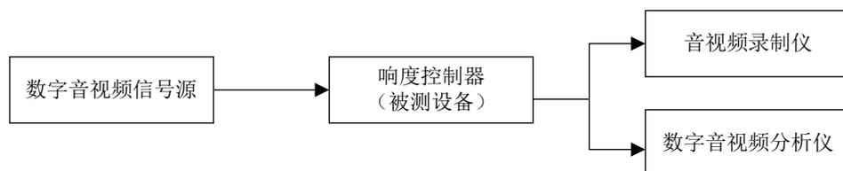
图11 音频质量测量框图
